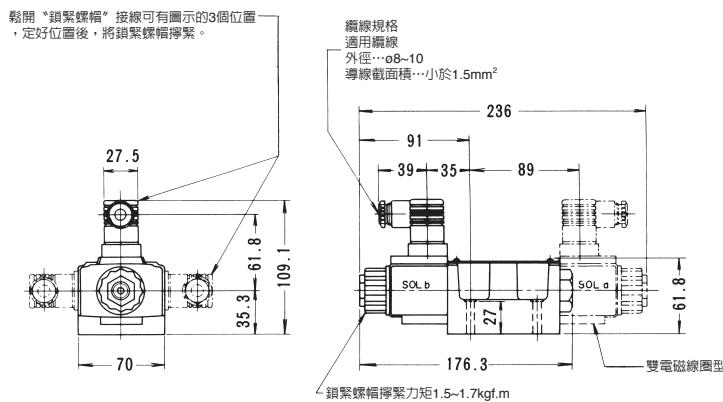
帶直流電磁鐵：※-DSG-03 -※※※-D※-N/N1
