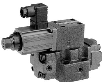
本閥為單純式比例減壓閥，配合專用放大器使用，可做無限段減壓，可使機械輕量化・簡單化・操作單純化。適用於工作機械・製鞋機械・專用機械等低壓小型化設備。
